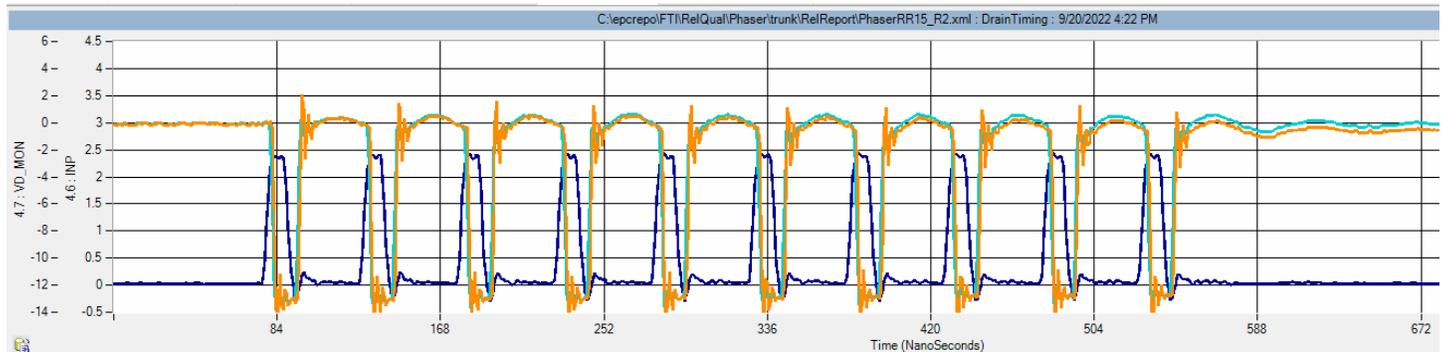
図20: 入力波形 (青色) と静止電流障害に対応する出力波形 (緑色と黄色)
